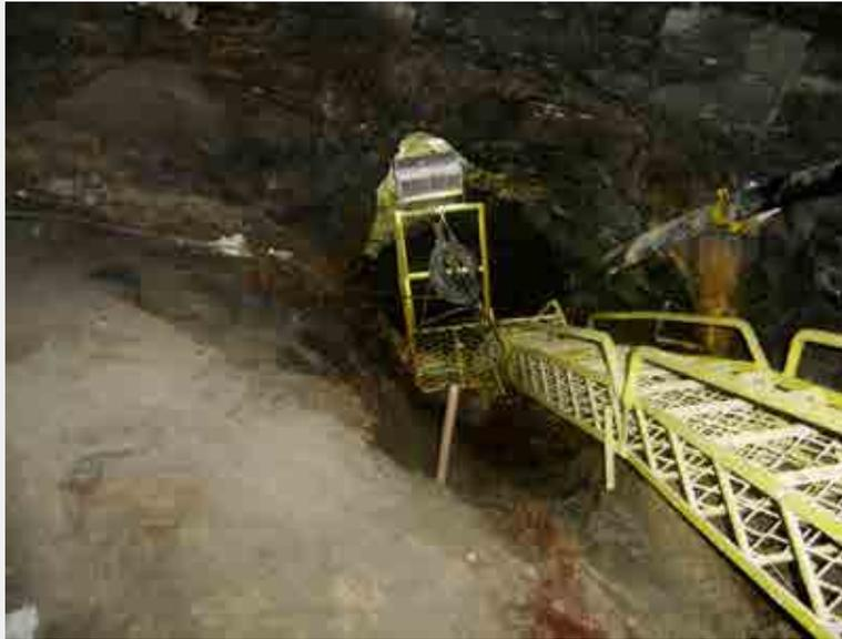
Escada de saída para saída de emergência de mina subterrânea
