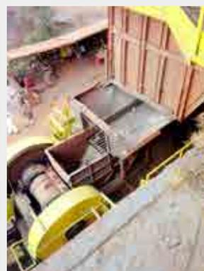
Partes móveis de britadores com proteção adequada
